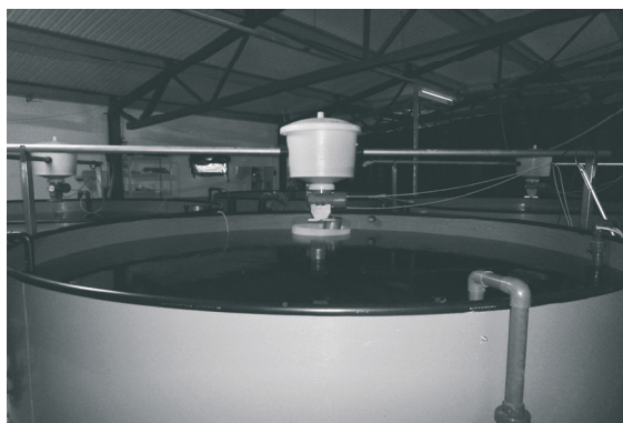
Рис. 23. Некоторые конструкции бассейнов для выращивания молоди сигов
