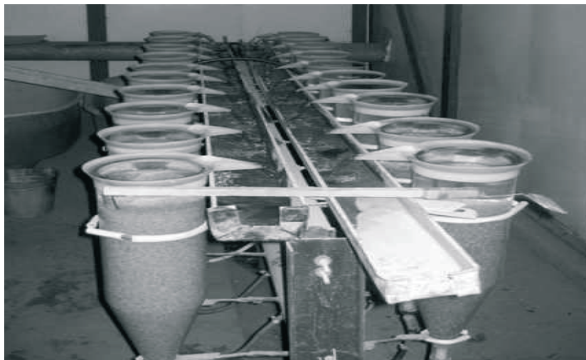
Рис. 19. Инкубационные аппараты Вейса с восходящим током воды в стойке (до 20 шт.)
