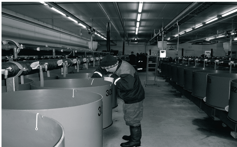
Рис. 24. Линии бассейнов с ленточной кормушкой (используются в Финляндии)
